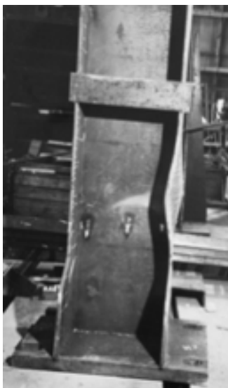
Рис. 20. Втрата місцевої стійкості полиці та ділянки стиснутої стінки колони
