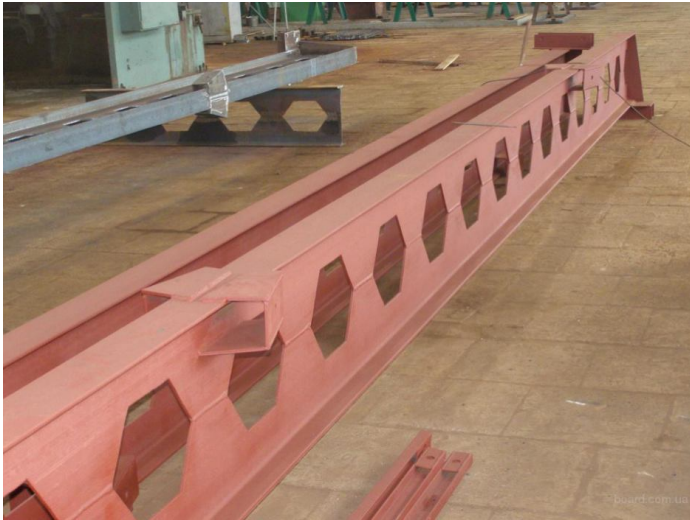
Рис. 1. Оптимізована стальна двотаврова балка з п'ятигранними отворами
